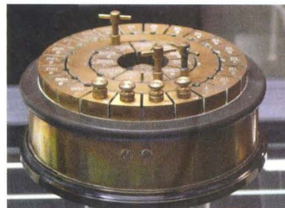
Obr. 10. Kompensograf, neboli kolíčkový reostat k polarografu Jaroslava Heyrovského, zařízení k úpravě elektrického odporu při měření slabých proudů
