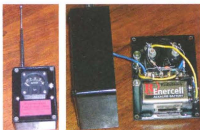
Obr. 13. Provedení měřiče síly AM signálu podle původního článku. Vpravo vedle stupnice je kapacitní trimr
