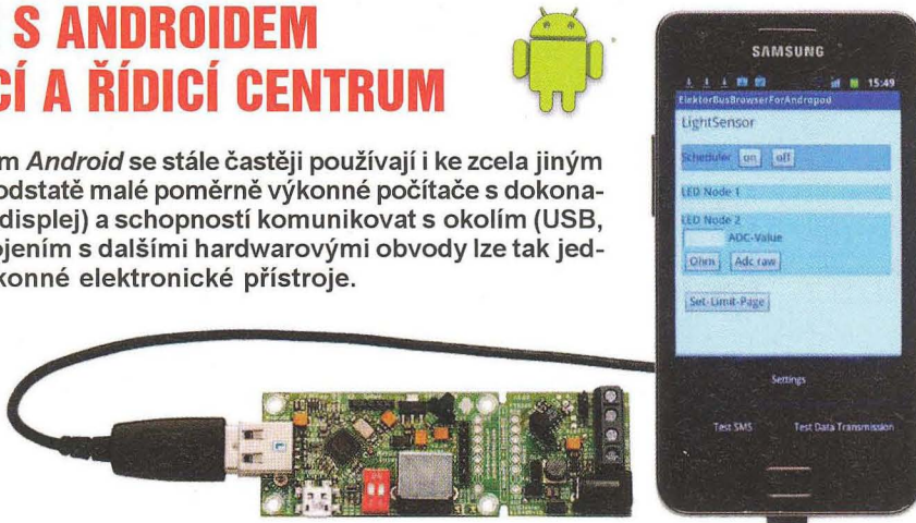
Modul pro připojení telefonu s OS Android k sériové lince RS232 (z časopisu Elektor )
