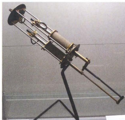
Obr. 7. Křížková oblouková lampička z roku 1884 s diferenciální regulací. Tento Křížkův patent umožňoval stabilní provoz více obloukových lamp připojených na jedno dynamo
