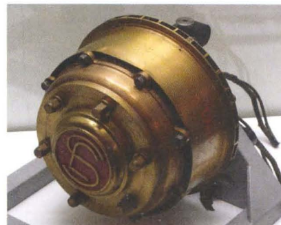
Obr. 11. Stejnoseměrný pomaluběžný nábojový trakční elektromotor pro automobil (1930 až 1931). Patent vynálezce Josefa Sousedíka
